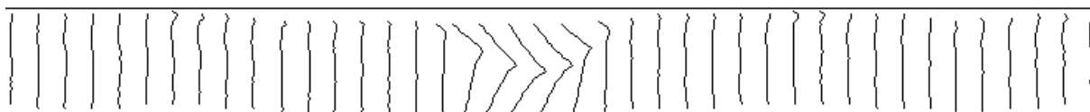
Przykład 13: Manewr omijania pojazdu stojącego na poboczu widoczny na wizualizacji równości poprzecznej na profilu liniowym
