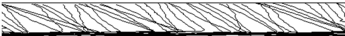
Przykład 8: Zakłócenia spowodowane odbiciem sygnału lasera od obiektów znajdujących się przy jezdni widoczne na wizualizacji równości poprzecznej na profilu liniowym
