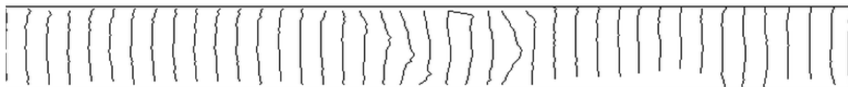
Przykład 16: Manewr wyprzedzania pojazdu widoczny na wizualizacji równości poprzecznej na profilu liniowym
